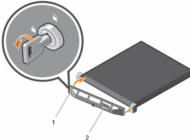
**Figure 19. Installing the Quick Sync bezel**
